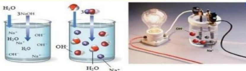
Gambar 24. Ionisasi larutan NaOH dan daya hantar listrik larutan NaOH (Sumber: Nivaldo, 2011)
