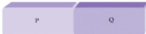
Ujung kiri P bersuhu  $90^\circ\text{C}$  dan ujung kanan Q bersuhu  $0^\circ\text{C}$ . Jika koefisien konduksi termal P adalah dua kali koefisien konduksi termal Q, berapakah temperatur pada bidang batas P dan Q?
