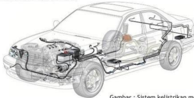
Gambar : Sistem kelistrikan mobil
