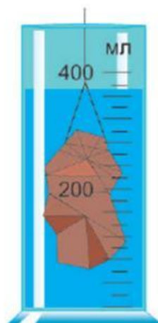
Мал. 2. Вимірювання об'єму тіла неправильної форми
