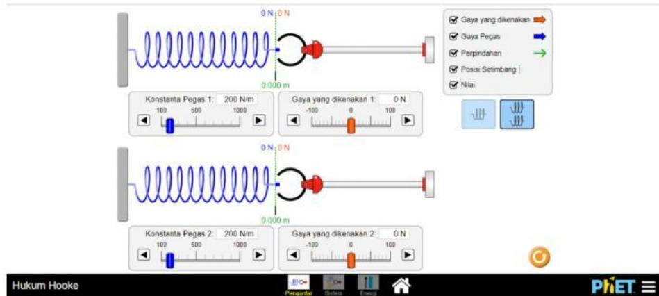
2. Tetapkan nilai konstanta pegas 200 N/m untuk sistem pegas yang atas dan 400 N/m untuk sistem pegas yang bawah
