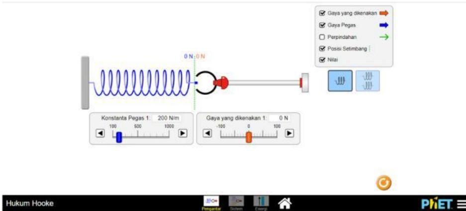
4. Tetapkan nilai konstanta pegas pada angka 200 N/m dengan mengatur posisi tombol biru pada kotak "konstanta pegas". Tariklah pegas dengan gaya 20 N dengan cara mengubah posisi tombol merah pada kotak "gaya yang dikenakan". Amatilah berapa nilai gaya pegas (gaya yang dilakukan oleh pegas kepada pemberi gaya)
