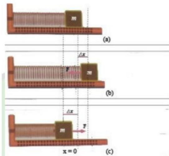
Gambar (a) Beban bermassa  $m$  diikatkan pada ujung pegas, (b) beban yang digerakkan ke kanan akan menarik pegas, dan (c) beban yang digerakkan ke kiri akan menekan pegas.
