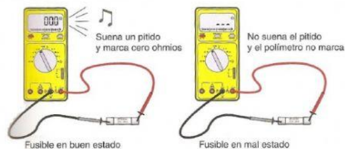
Figura 5.8. Comprobación de un fusible con polímetro.
