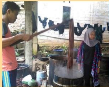
Gambar 3. Pencucian batik dengan air panas
