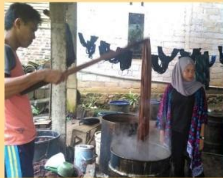
Gambar 3. Pencucian batik dengan air panas
