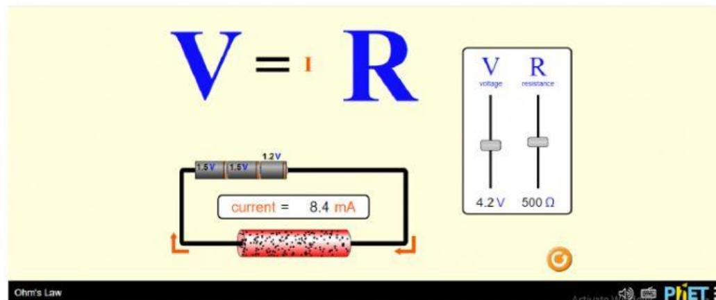
3. Terdapat beberapa menu untuk mengubah nilai tegangan listrik (V) dan hambatan atau resistor rangkaian (R)
