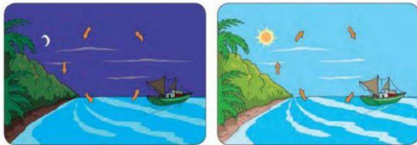
Perpindahan kalor secara konveksi ialah perpindahan kalor yang disertai dengan perpindahan zat perantaranya. Umumnya peristiwa perpindahan kalor secara konveksi terjadi pada zat cair dan gas. Zat yang menerima kalor akan memuoi dan menjadi lebih ringan sehingga akan bergerak ke atas. Saat zat yang lebih ringan tersebut pindah ke atas, molekul zat yang ada di atasnya akan mengantikannya.
