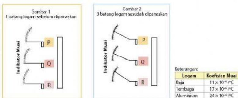
Berdasarkan ilustrasi percobaan dan data koefisien muai panjang logam, yang menunjukkan batang baja, tembaga, dan aluminium yang benar secara berurutan adalah ....
