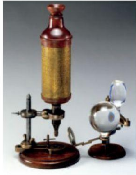
Robert Hooke observó células por primera vez con este microscopio que llegaba a los 50 aumentos. Este sencillo aparato fue construido por él mismo.
