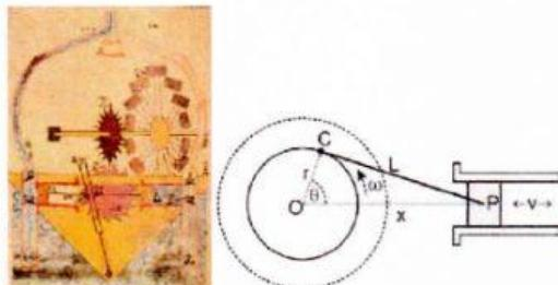
Lingkaran engkol dapat bergerak rotasi dengan kecepatan sudut  $\omega$  terhubung dengan piston yang bergerak translasi dengan kecepatan  $v$ . Berdasarkan desain tersebut, diketahui jari-jari engkol sebesar  $r$ , batang penghubung engkol dan piston panjangnya adalah  $L$ . Kecepatan translasi piston sepanjang garis  $x$  adalah...
