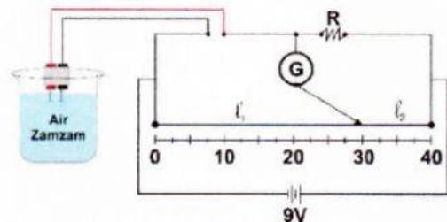
Jika diketahui  $l_1 = 10 \text{ cm}$ ,  $l_2 = 30 \text{ cm}$ , dan  $R = 2700 \Omega$  maka hambatan jenis air zam-zam jika luas permukaan elektroda yang berinteraksi  $A = 0,000117 \text{ m}^2$  dan jarak antara dua elektroda  $l = 0,009 \text{ m}$  adalah...
