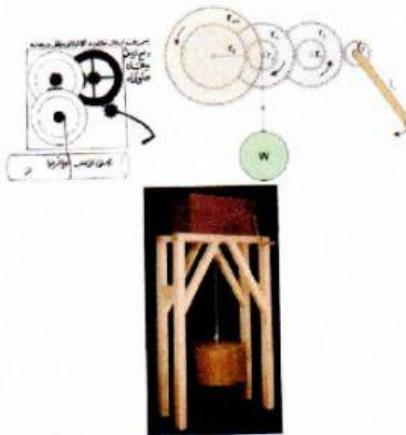
Jika diketahui  $I_{\text{pemutar}} = 8r$ ,  $r_1 = r_3 = r_5 = r$ ,  $r_2 = r_4 = r_6 = 3r$ ,  $r_{\text{tali}} = 4r$ , dan berat beban  $108 \text{ N}$ , maka gaya minimal untuk dapat mengangkat beban tersebut adalah...
