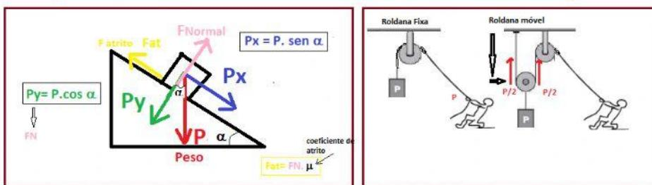
**1- (Ufal)** Uma rampa AB, inclinada de  $37^\circ$  em relação à horizontal, tem 12 m de comprimento e não oferece atrito para um pequeno corpo de massa 1,0 kg, abandonado, a partir do repouso no ponto A. Adote  $g = 10 \text{ m/s}^2$ ,  $\cos 37^\circ = 0,80$  e  $\operatorname{sen} 37^\circ = 0,60$ . Determine:
