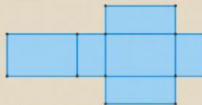
Jaring-jaring bak penampungan air
