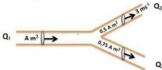
Fluida ideal mengalir pada pipa mendatar dengan luas penampang  $A \text{ m}^2$  kemudian fluida mengalir air pada dua pipa yang luas penampangnya lebih kecil seperti terlihat pada gambar. Perbandingkan kecepatan aliran fluida pada pipa yang luas penampangnya  $0,75 \text{ A m}^2$  dengan kecepatan aliran fluida pada pipa yang luas penampangnya  $0,5 \text{ A m}^2$  adalah....
