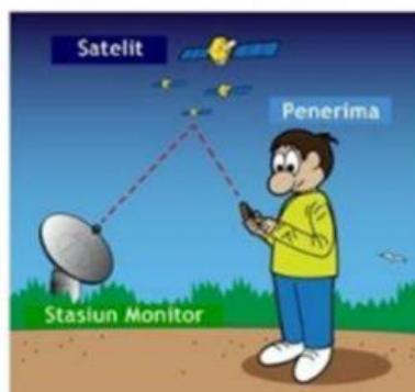
Bagaimana cara GPS menentukan jarak posisimu dengan posisi temanmu di suatu wilayah? Alat penerima menerima sinyal dari satelit-satelit yang ada di angkasa sehingga dapat dihitung jarak posisimu dengan stasiun monitor. Dengan cara yang sama dapat diketahui posisi temanmu di wilayah lain. Setelah itu, dapat diketahui secara pasti jarak posisimu dan
