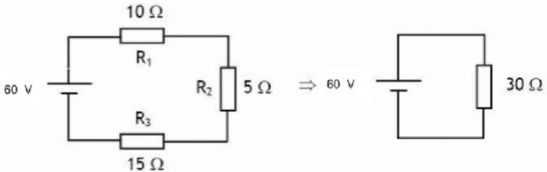
En la imagen anterior se muestra un circuito con 3 resistencias. Además se muestra que a efectos de la ley de ohm, se puede asemejar al circuito de la derecha, de cara a poder calcular la intensidad.
