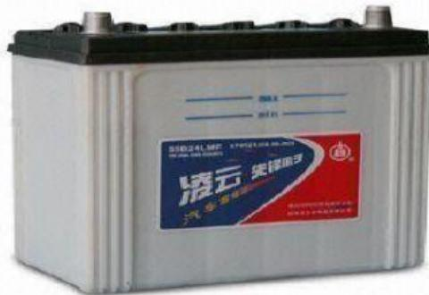
The Lead Storage Battery dikenal dengan sebutan baterai mobil atau aki/accu. Baterai penyimpan plumbum (timbal) terdiri dari enam sel yang terhubung secara seri. Anoda pada setiap sel adalah plumbum (Pb), sedangkan katodanya adalah plumbum dioksida ( $\text{PbO}_2$ ). Elektroda dicelupkan ke dalam larutan asam sulfat ( $\text{H}_2\text{SO}_4$ ).
