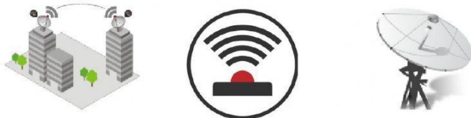
7. En un sistema de **microondas** se usa el espacio aéreo como medio físico de transmisión. La información se transmite en forma digital a través de ondas de radio de muy corta longitud. Pueden direccionarse múltiples canales a múltiples estaciones dentro de un enlace dado, o pueden establecer enlaces punto a punto. **La definición anterior hace referencia a:**
