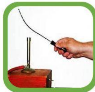
Gambar 4.4 Saat dipanaskan bimetal melengkung
