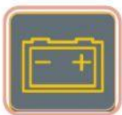
Figura 7: Marcador da carga da bateria do trator
