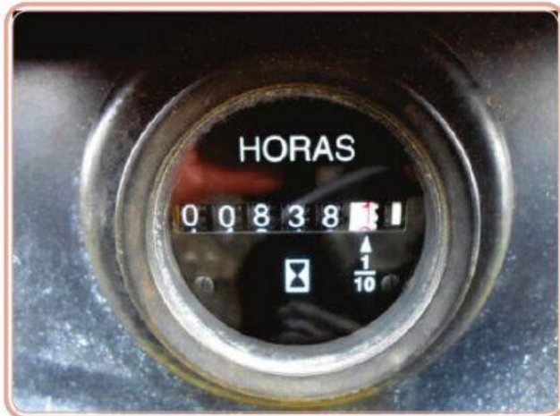
Figura 2: Modelo de horímetro utilizado em tratores agrícolas
