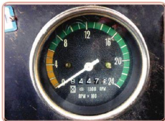
Figura 4: Modelo de tacómetro de um trator agrícola
