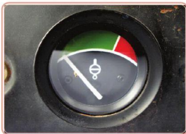
Figura 3: Marcador de temperatura da água do sistema de arrefecimento
