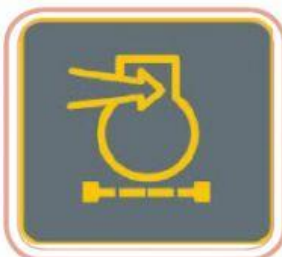
Figura 10: Marcador de restrição do filtro de ar
