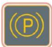
Figura 8: Marcador de alerta do freio de estacionamento
