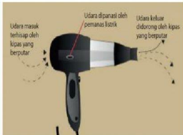
Pemanfaatan perpindahan kalor secara konveksi pada bidang teknologi (Oven dan Pengering Rambut)
