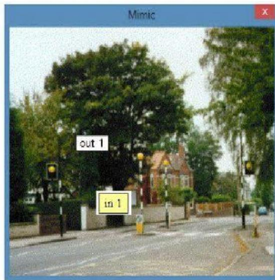
Un paso a nivel indica con unas luces que parpadean cada segundo (out 1), cuando se acciona el pulsador (in 1), para avisar que un coche va a pasar.
