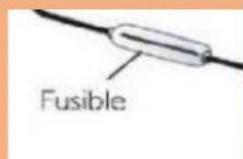
Componente eléctrico hecho de un material conductor, generalmente estafado, que tiene un punto de fusión muy bajo y se coloca en un punto del circuito eléctrico para interrumpir la corriente cuando esta es excesiva
