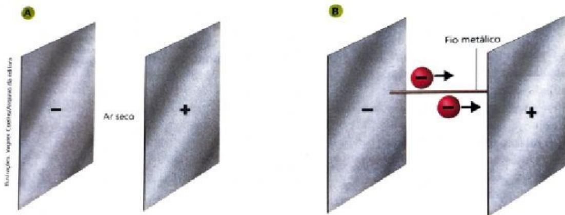
Na situação "A", existe atração elétrica entre as placas carregadas, em virtudes de suas cargas opostas, mas os elétrons da placa à esquerda continuam restritos à sua superfície por causa da ação isolante do ar. Há uma energia potencial elétrica nesse sistema, representada pelas partículas portadoras de carga elétrica. É energia armazenada, pronta para ser transformada em outra forma de energia, a energia cinética, ou de movimento, dessas partículas.
