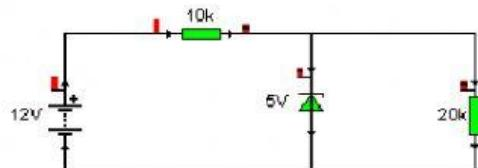
5.-Qué valor debería tener la pila, para que por el diodo bajaran 2 mA. (En voltios con 1 decimal)
