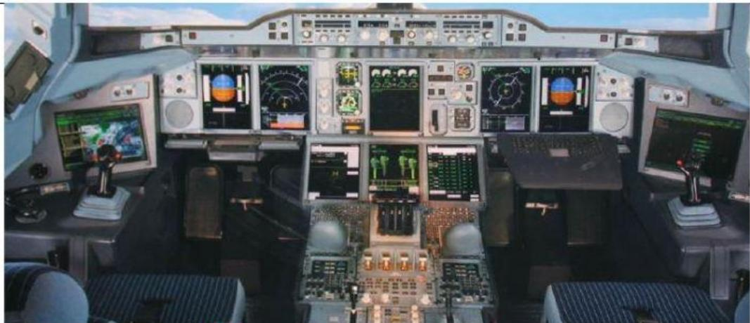
**EFIS** Es un sistema de gestión de vuelos que está armado dentro de los aviones y permite el manejo de todos los controles en la cabina de vuelo. Su nombre proviene del acrónimo Electronic Flight Instrument System que significa Sistema Instrumental de Vuelo Electrónico.
