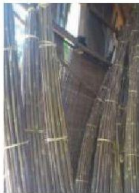
Sumber: http://klungbot.com Gambar 3.12 Bahan bambu disimpan sampai cukup kering
