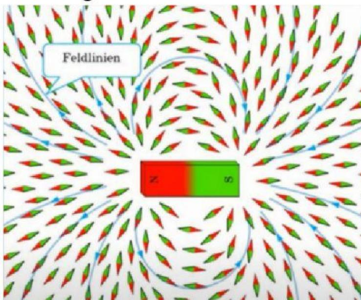
**Bringen wir magnetische Nadeln in den Bereich eines Magneten, so ordnen sich diese und zeigen den Verlauf der magnetischen Feldlinien an.**
