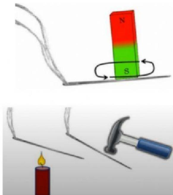
**Wird er stark erhitzt oder erschüttert, so verliert ein Magnet seine magnetische Eigenschaft, er wird dadurch**
