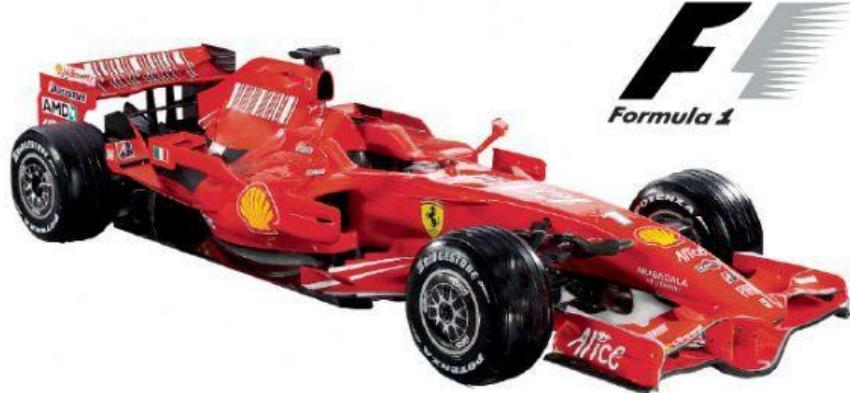
Un carro de Fórmula 1 es como un rompecabezas. Primero se construye un motor 9 veces más potente que el de un carro común. Así, alcanza grandes velocidades. Pero a una velocidad de más de 100 km/h el aire puede frenar o levantar un auto de manera incontrolable. Entonces se crea una carrocería que permite al aire pasar sin problema sobre el carro, para evitar este efecto.
