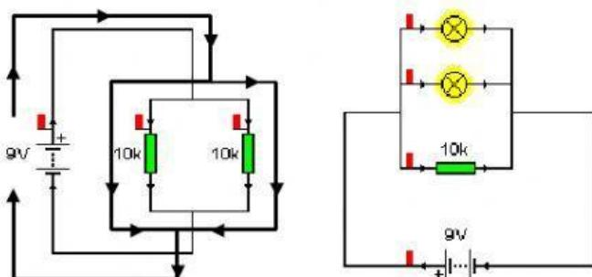
En las conexiones en paralelo, todos los componentes están sometidos al mismo voltaje porque desde sus extremos se puede llegar directamente a la pila sin pasar por otro componente, simplemente recorriendo cable.
