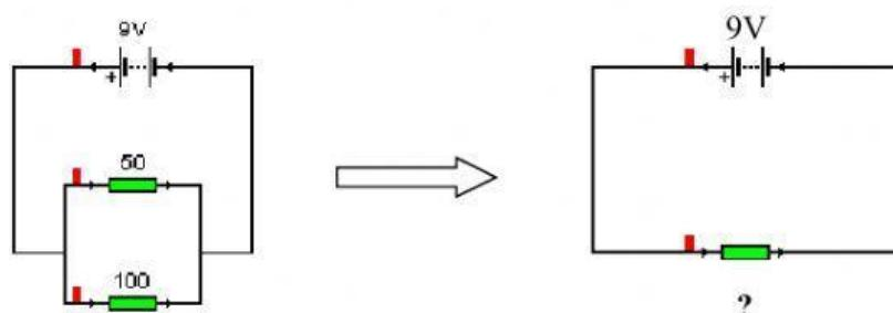
Se puede hacer más rápido usando esta fórmula  $R_T = \frac{R_1 \cdot R_2}{R_1 + R_2}$
