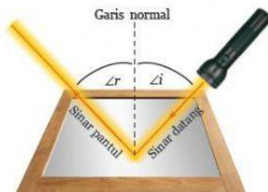
Sumber: Dok. Kemdikbud Gambar 11.4 Proses Pemantulan Cahaya pada Cermin Datar
