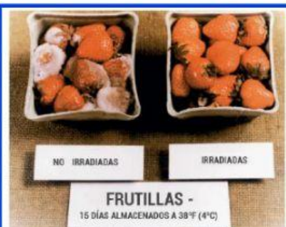
Las frutillas irradiadas a 200 kilorads (derecha) siguen frescas después de 15 días de almacenamiento a 4°C; las que no se irradiaron se enmohecieron.
