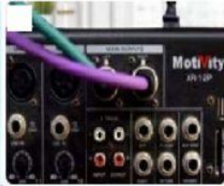
Sambungkan kabel ke terminal OUT L/R pengadun.
