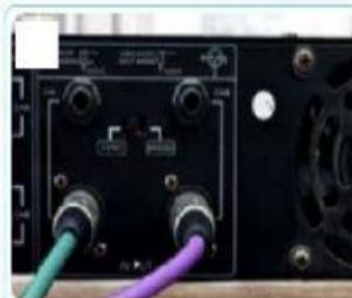
Sambungkan kabel dari terminal OUT L/R pengadun ke terminal INPUT L/R penguat.
