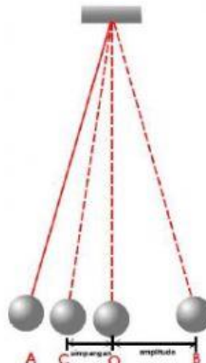
Gambar 1.3 Perbedaan antara simpangan dan amplitudo
