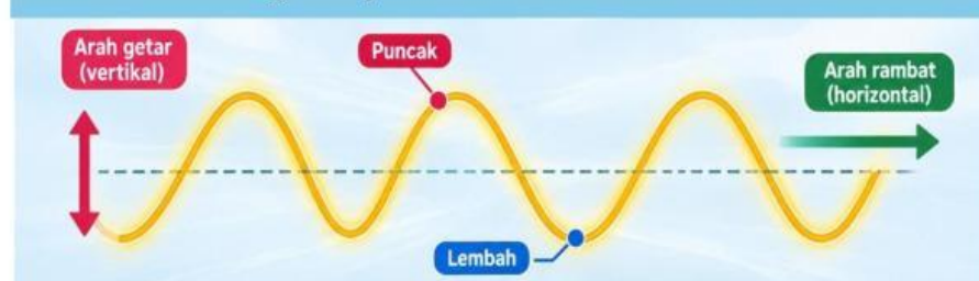
Gambar 3. Gelombang transversal pada cahaya dengan label arah getar, arah rambat, puncak, dan lembah
