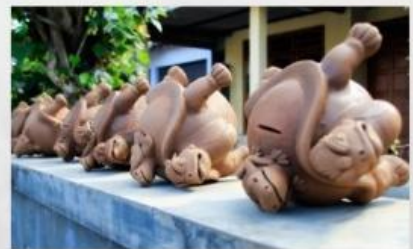
Gambar 2. Gerabah dikeringkan sebelum dibakar Sumber : indonesiakaya.com
