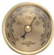
Barómetro mide la presión atmosférica
