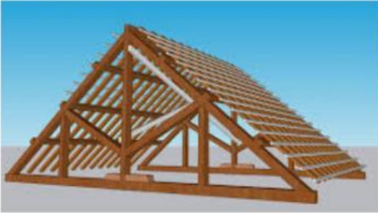
Gambar 2.12. Kuda-kuda Kayu (Sumber: 3D Warehouse)
