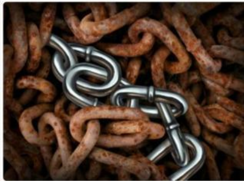
Gambar 1. Besi yang mengalami perkaratan
