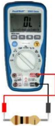
รูปที่ 6.1 การวัดตัวต้านทานโดยใช้แอมมิเตอร์และดิจิตอลมิเตอร์
