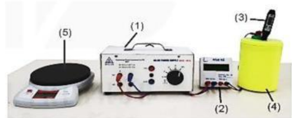
Hình 4.1. Bộ thí nghiệm thực hành đo nhiệt dung riêng của nước
