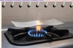
Sebuah pelat logam tipis diletakkan di atas kompor dengan nyala api kecil yang hanya mengenai bagian tengah pelat. Setelah beberapa saat dipanaskan, pelat tersebut tampak melengkung ke atas pada bagian tengahnya. Ketika api dimatikan dan pelat dibiarkan mendingin secara alami, bentuk pelat perlakan kembali mendekati bentuk semula. Perubahan bentuk pelat ini terjadi karena ....
