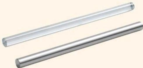
Sebatang kaca dan sabatang aluminium, masing-masing memiliki panjang 50 cm pada suhu 20°C. Kedua batang dipanaskan hingga suhu 60°C. Berdasarkan sifat masing-masing bahan, perubahan panjang yang terjadi pada kedua batang adalah...
