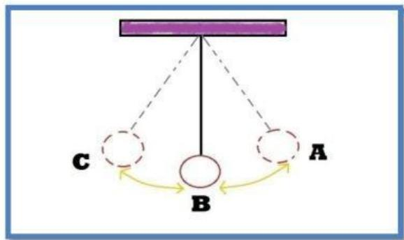
Gerakan bolak – balik benda melalui titik keseimbangan secara periodik dan teratur. Misalnya pada gambar ayunan bandul, titik awal benda pada titik A, maka benda dikatakan melakukan satu gerakan apabila dari A – B – C – B – A. Apabila titik awal benda di B, maka benda dikatakan melakukan satu gerakan apabila dari B – A – B – C – B. Simpangan terjauh benda dikatakan sebagai amplitudo.
