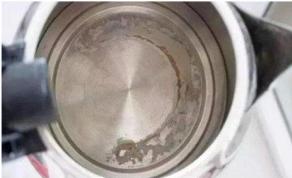
(Gambar Terbentuknya endapan pada pemanas air / kettle)
