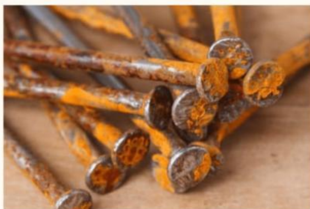
Gambar 1. Contoh korosi pada paku (Sumber: Kompas.com)
