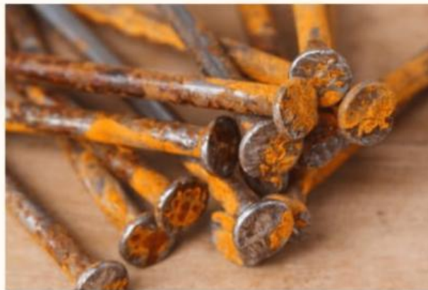
Gambar 1. Contoh korosi pada paku (Sumber: Kompas.com)
