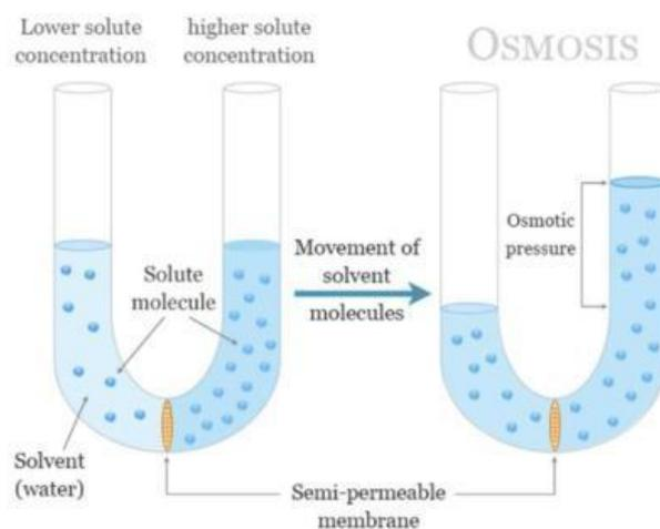
Pada sistem tersebut terdapat membran semipermeabel yang memisahkan dua larutan dengan konsentrasi zat terlarut berbeda. Pada gambar tampak adanya perbedaan ketinggian kolom cairan pada kedua sisi tabung.
