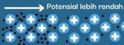
Gambar 12. Elektron membawa muatan listrik menuju potensial rendah, sehingga terjadi aliran listrik
