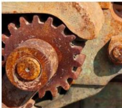
b) Perkaratan besi 2Fe(OH)_3(s) \rightarrow Fe_2O_3 \cdot 3H_2O(s)
