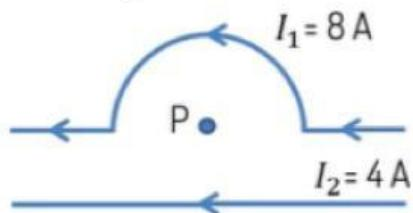
Arus listrik yang mengalir pada kawat melingkar dan kawat lurus berturut turut adalah 8 A dan 4 A. Di titik P terletak pada pusat lingkaran dari kawat yang membentuk setengah
